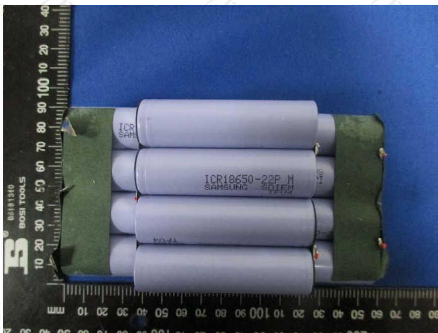
Photo 3 Internal Cell 内部电芯
