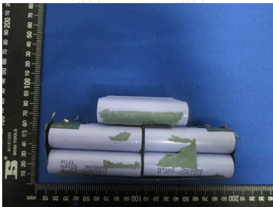
Photo 4 Internal Cell 内部电芯
